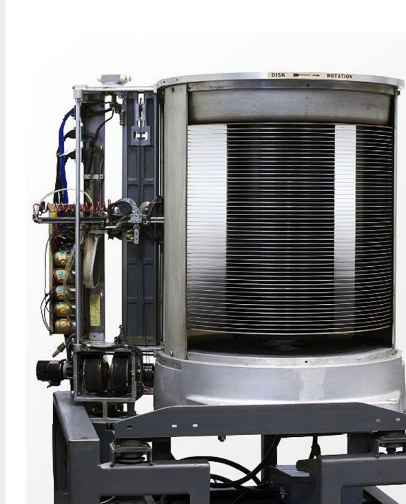
RAMAC – 1956 Magnetický pevný disk (5MB)
